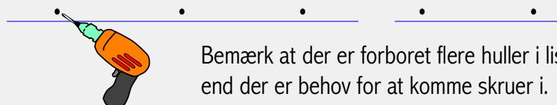
Bemærk at der er forboret flere huller i listen end der er behov for at komme skruer i. Det er af hensyn til hvis man kommer til at bore et svagt sted i væggen.
